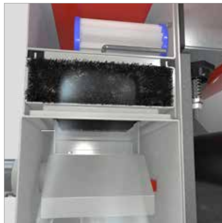
Weiteres Abscheiden der Flüssigkeit
